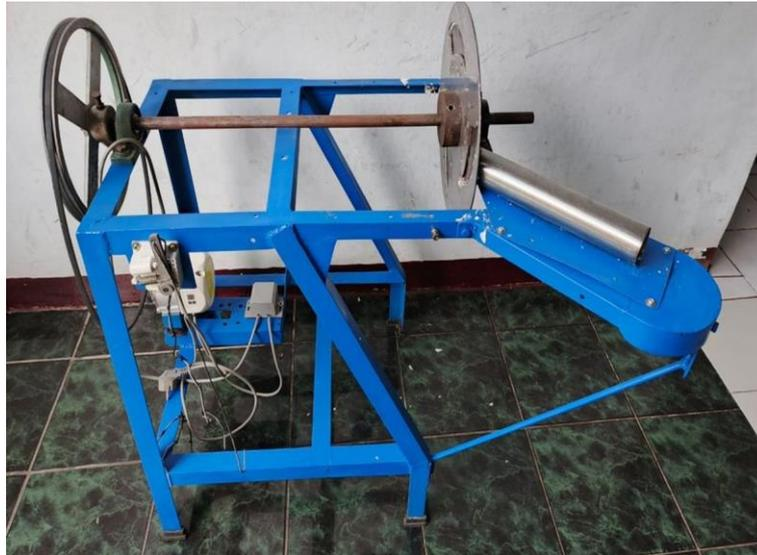
Gambar 2. Mesin pengiris pisang terintegrasi penggorengan tampak samping
