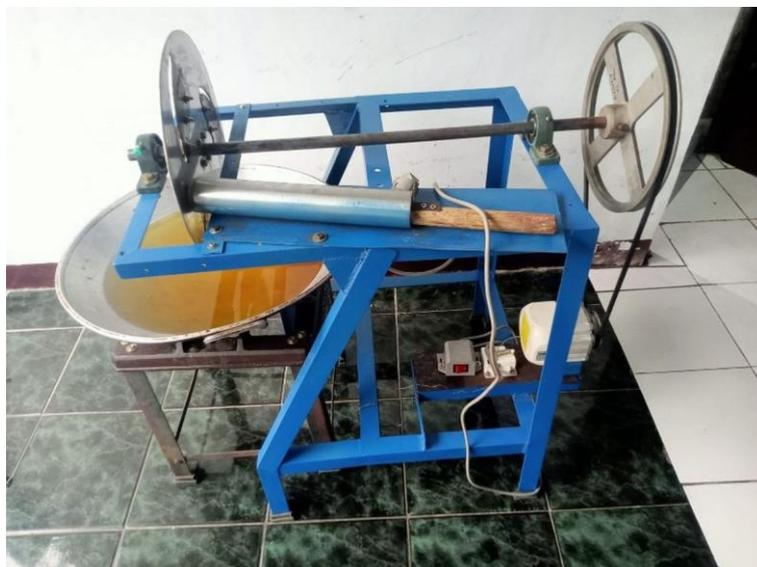
Gambar 3. Mesin pengiris pisang terintegrasi penggorengan sudah disiapkan untuk proses pengirisan dengan penggorengan berisi minyak yang dipanaskan di atas kompor.
