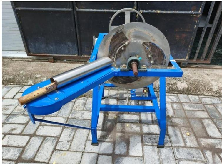
Gambar 1. Mesin pengiris pisang terintegrasi penggorengan tampak depan
